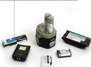
La pile à hydruure métallique de nickel.
