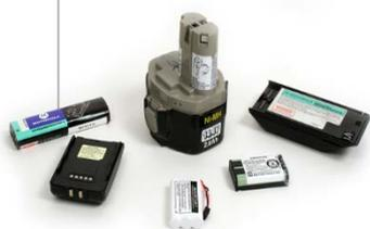
La pile à hydruure métallique de nickel est très performante dans les appareils énergivores et peut être rechargée jusqu'à 1 000 fois. Elle ne contient pas de cadmium, mais peut coûter cher.
